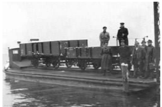
Das 1945 in Betrieb gegangene Trajekttschiff Resi mit Güterwagen zwecks Revision in Attersee
